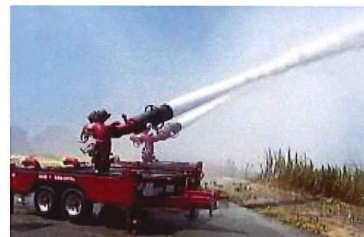
【屋外放水設備】
